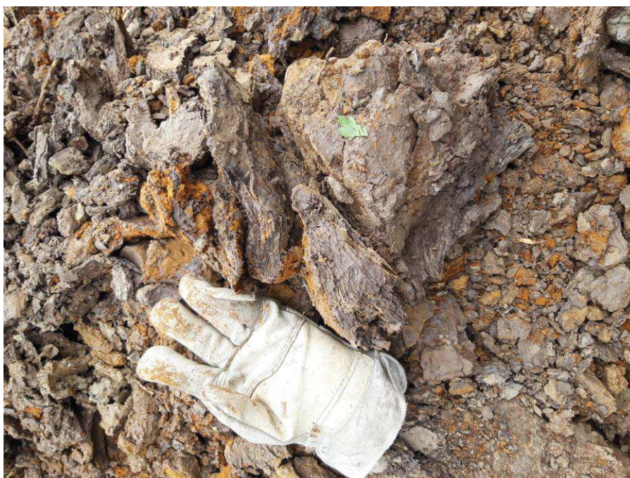
Foto č.1 – KS-2 deformace lamin v hloubce cca 1,5 m pod terénem
